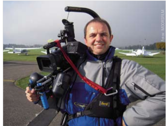
Als Basis dient ein Easyrig, an dessen Bügel die Kamera hängt. Mit elektrischen Kreiseln, die in Neigung und Position exakt austariert sind, wird das Bild stabilisiert.
